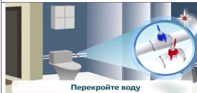
Для того чтобы исключить возможность затопления. Необходимо отключить горячую и холодную воду. Для этого необходимо повернуть краны в положение «Закрыто».
